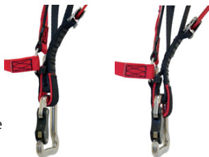
Figure 5 : vous pouvez réduire la dérive du parapente (opposée à la rotation de l'hélice avec la TEA ou la boucle interne supplémentaire au point d'attache . haut. Rappelez vous cependant qu'avec la TEA vous pouvez mettre un noeud exactement où c'est nécessaire pour compenser l'effet de couple, alors que la boucle n'a pas de réglages possibles.
