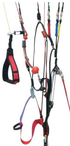
Figure 3 : point d'attache bas (ligne de frein passant à travers une poulie en position haute). Clip magnétique placé haut.
