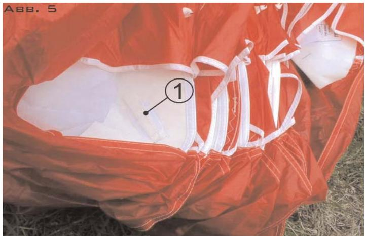
So sieht der fertig geraffte Schirm aus. Jetzt kann der hintere Teil Bahn für Bahn zusammengelegt und schließlich eingerollt werden.
