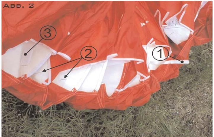
Dabei jede aufgefädelt Mylar-Verstärkung sauber auf die bereits zuvor aufgefädelt Verstärkungen pressen. So entsteht ein stabiler Packen, der vor Knicken schützt.
